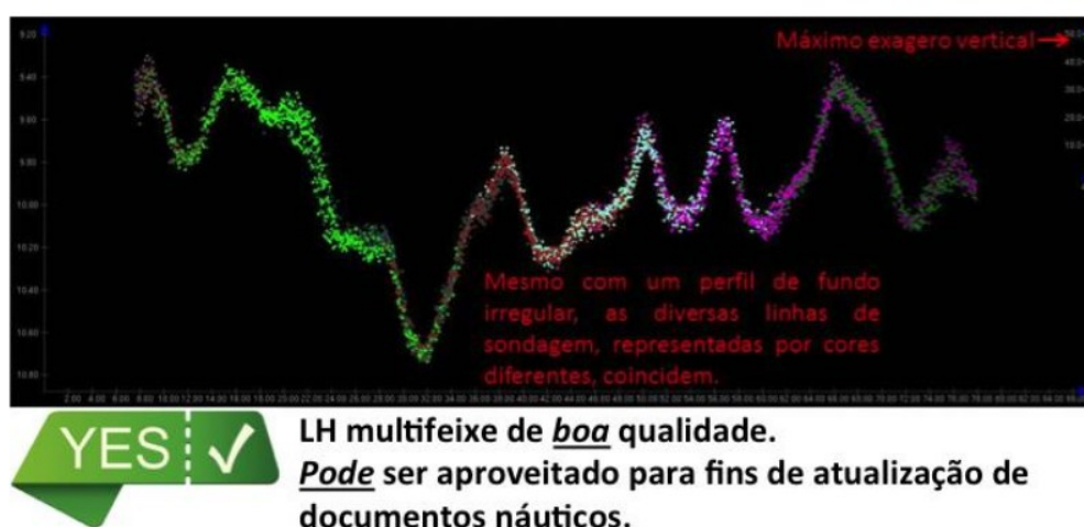
Figura 8 – Exemplo de “coincidência” dos perfis batimétricos provenientes de varreduras sobrepostas
