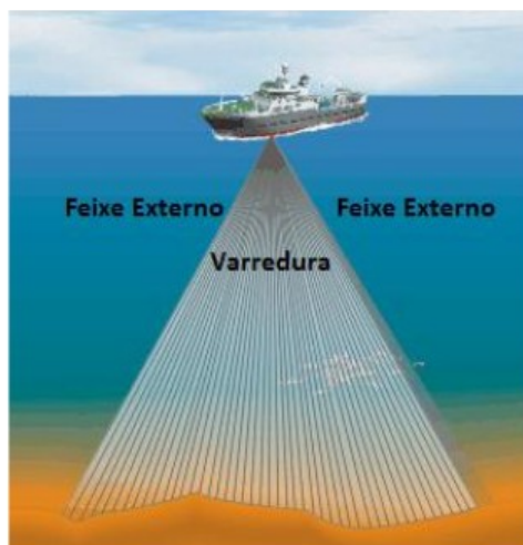
Figura 5 - Varredura Multifeixe. Figura adaptada de www.simrad.com .
